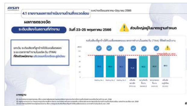
รูปที่ ๔ ผลการตรวจวัดระดับเสียงที่ลูกจ้างได้รับเฉลี่ยตลอดระยะเวลาการทำงานในแต่ละวัน (TWA) ที่ติดตัวพนักงาน บริเวณเครื่องฉีดอะลูมิเนียม
